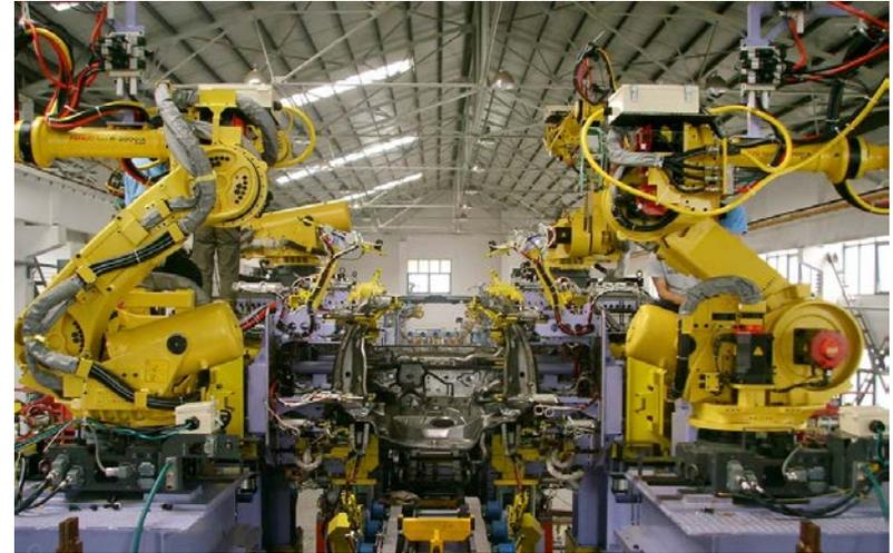
自動車溶接ラインの中のロボットシステム
